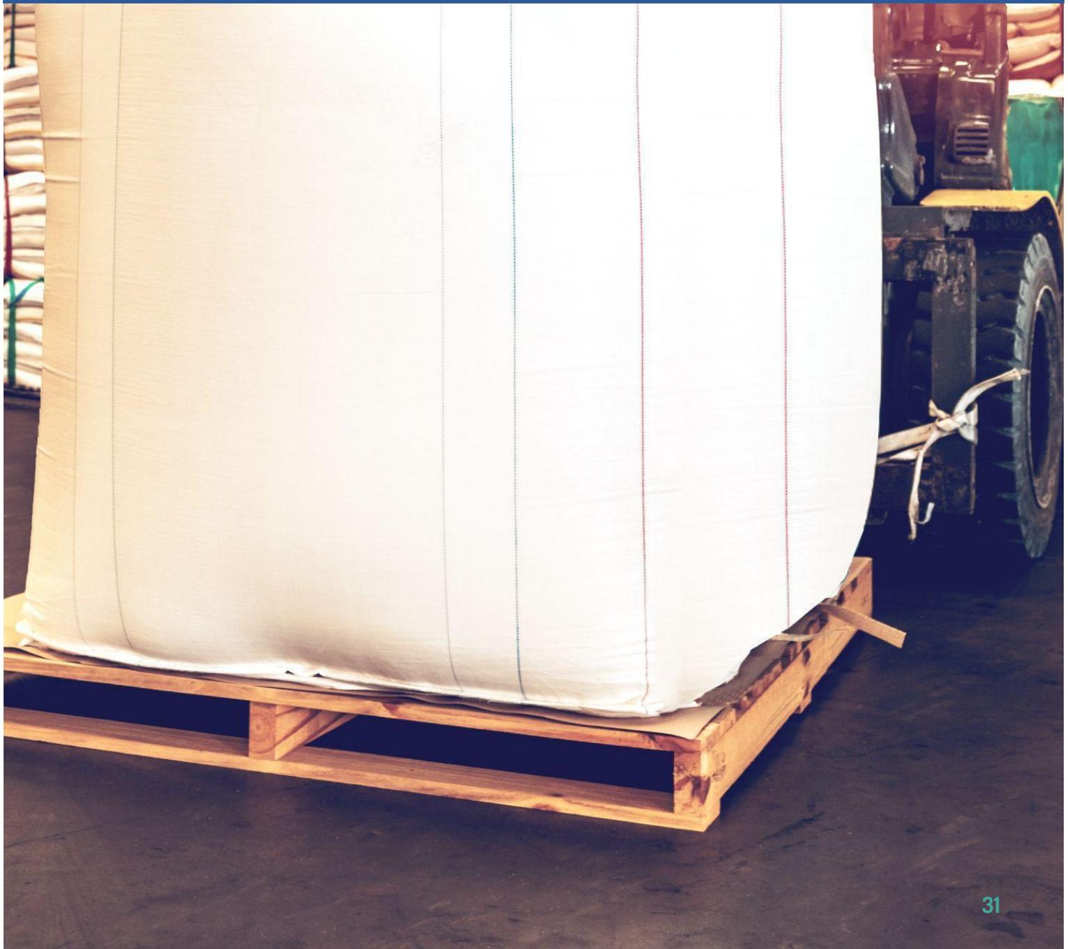
In diesem Anwendungsfall wurden Einwegtransportverpackungen aus Kunststoff, insbesondere 1-Kubikmeter-Bigbags (Flexible Intermediate Bulk Container - FIBCs), mit wiederverwendbaren Kunststoff-Bigbags der gleichen Größe verglichen.
